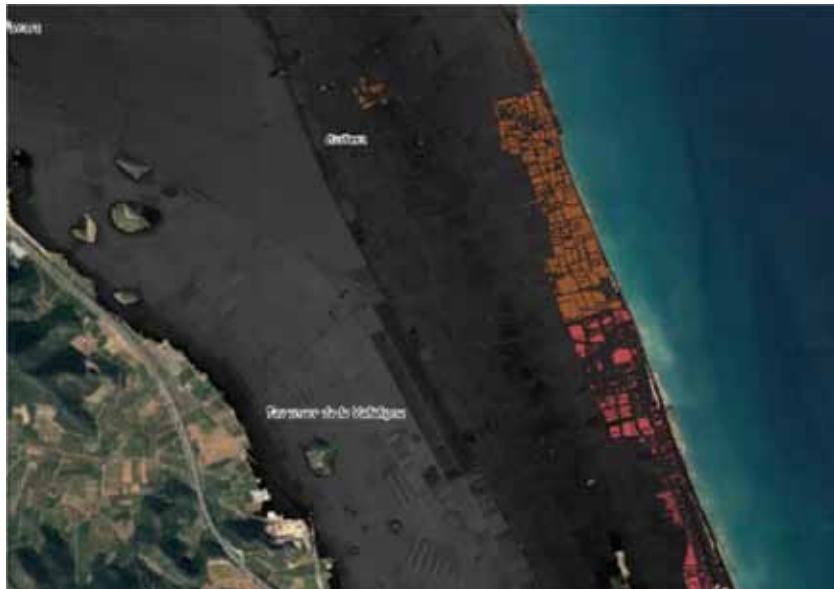
Imagen 1. Zona de inundación ( T_r=500 años) en la situación actual ubicando los elementos afectados por municipios.
